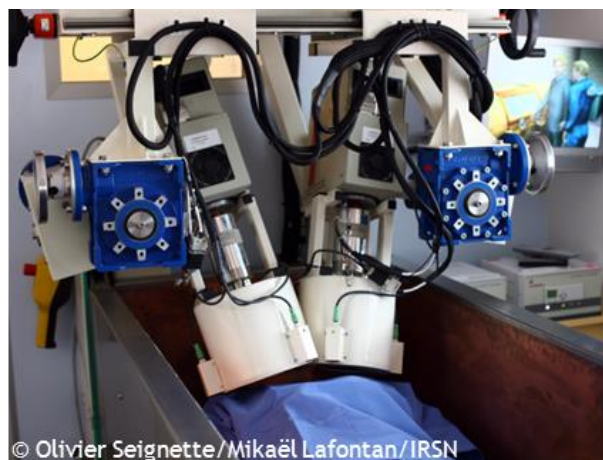
Figure 21 - Mesure anthroporadiométrique pulmonaire à l'aide de détecteurs GeHP
